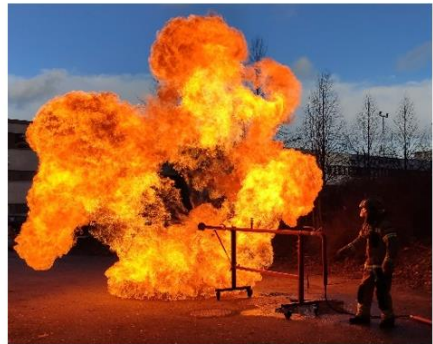
Kuva 4: Vasemmanpuoleisessa kuvassa nestekaasua käytetään kaasumaisessa muodossa. Oikeanpuoleisessa kuvassa nestekaasu otetaan laitteelle nestemäisenä. Kuvapari näkee, miten tuliefektin luonne ja sen vaatimat turvallisuusjärjestelyt muuttuvat. (Kuvat: Juha-Pekka Koski, Helsingin kaupungin pelastuslaitos)
